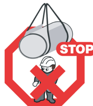
No puede permanecer personas debajo de la carga, mientras dure la maniobra
