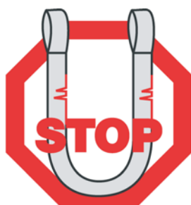
No utilizar una eslinga DAÑADA
